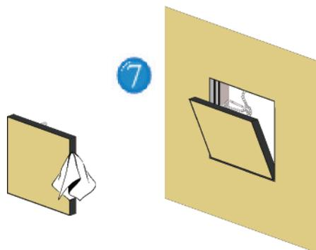
Posez le panneau de porte avec les tenons en aluminium en bas dans les trous préparés du cadre extérieur. Par mesure de sécurité accrochez le dispositif de sécurité et fermez la trappe de visite.
