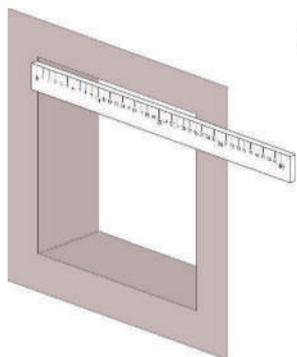
Contrôlez les dimensions de la réservation dans le mur et de la trappe de visite.
