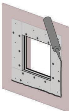
Fermez le joint périphérique entre la trappe de visite et le mur massif avec de l'enduit ou du plâtre.
