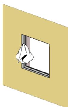
Nettoyez soigneusement les deux cadres en aluminium de la trappe de visite après l'application de l'enduit et également de la peinture. Ceci est très important pour que la fonction de la trappe ne soit pas entravée.
