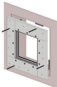
Prenez le cadre extérieur et insérez-le dans la réservation. Veuillez faire **attention au sens d'ouverture**: les fermetures à ressort doivent être en haut. Pressez le cadre extérieur aux équerres de fixation murale et vissez le cadre aux équerres.
