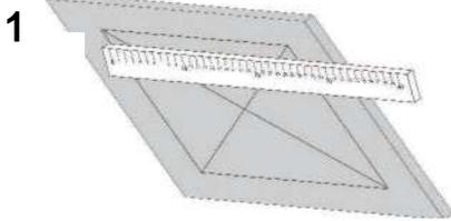
Marquez la découpe sur le plafond en plaques de plâtre à l'aide d'une équerre à angle droit. Dimension de la trappe + 225 mm.
