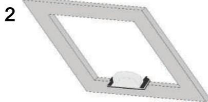
Découpez l'ouverture dans la plaque. (scie sauteuse, scie à guichet...) Veillez à ce que les bords soient droits et propres.
