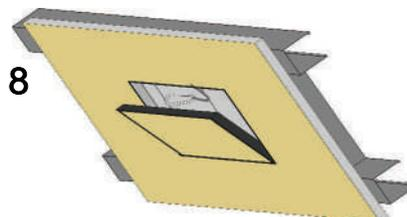
Remettez les plaques de protection à leur place. Par mesure de sécurité accrochez le dispositif de sécurité et fermez la trappe de visite.
