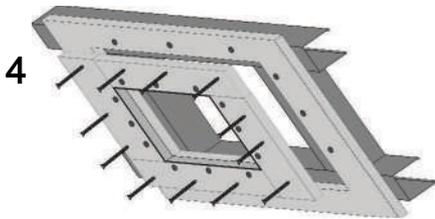
Enlevez le panneau de porte et les plaques de protection du cadre extérieur et pressez ce dernier au devant des profilés F45. Vissez le cadre extérieur à l'aide de vis TTPC aux profilés F45 avec un entraxe de max. 130 mm.
