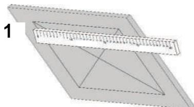
1 Marquez la découpe sur le plafond en plaques de plâtre à l'aide d'une équerre à angle droit. (dimension de la trappe +185 mm).
