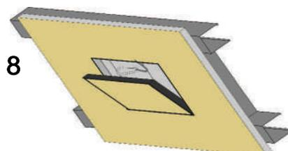
8 Remettez les plaques de protection à leur place. Par mesure de sécurité accrochez le dispositif de sécurité et fermez la trappe de visite.
