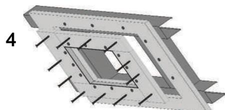
4 Enlevez le panneau de porte et les plaques de protection du cadre extérieur et pressez ce dernier sur le devant des profilés F45. Vissez le cadre extérieur à l'aide de vis TTPC aux profilés F45 avec un extraxe de max. 130 mm.
