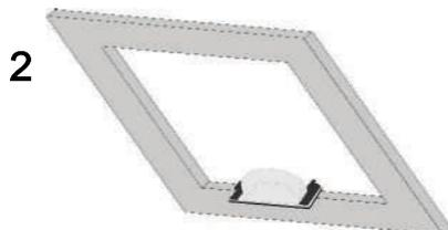
2 Découpez l'ouverture dans la plaque. (scie sauteuse, scie à guichet...) Veillez à ce que les bords soient droits et propres.
